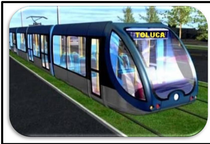
Imagen 20. Propuesta de Tranvía Citadis 402 con siete módulos para la ciudad de Toluca (Modificada).
